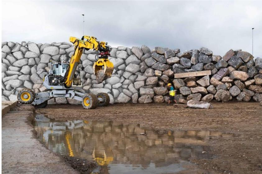
*Excavadora recoge y escanea cada roca para colocarla en la posición correcta. Parque Circularity en Oberglatt, Eberhard AG.*
