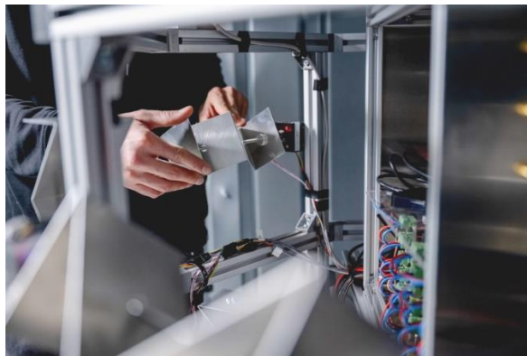
Espejos ajustables son el corazón de la tecnología de ondas de radio. Crédito: Universidad del Ruhr de Bochum
