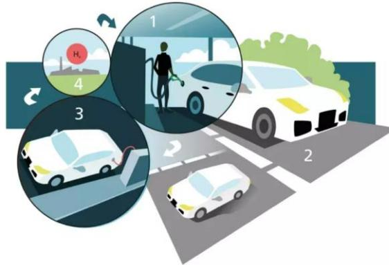
*Automóvil se recarga con líquido que contiene hidrógeno. Combustible pasa a través del convertidor catalítico, donde libera hidrógeno a una pila de combustible. Cuando se acaba el hidrógeno, se drena y se llena con líquido nuevo en la gasolinera.*
