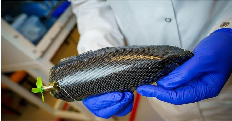
*Este barco en miniatura está construido con un supercondensador estructural, un material que proporciona tanto soporte estructural como capacidad de almacenamiento de energía.*
