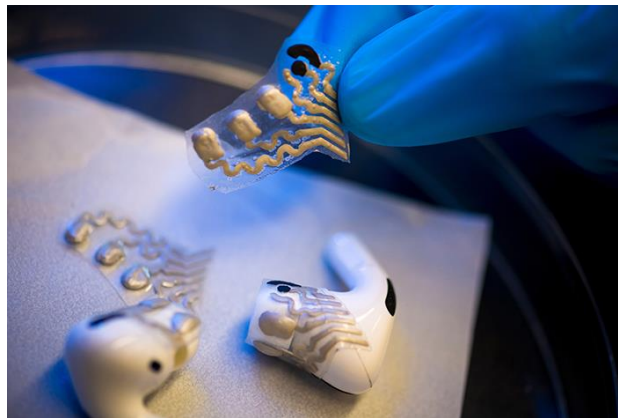
Sensores flexibles serigrafiados están sujetos a los auriculares en una superficie flexible similar a un sello. Crédito: Universidad de California – San Diego
