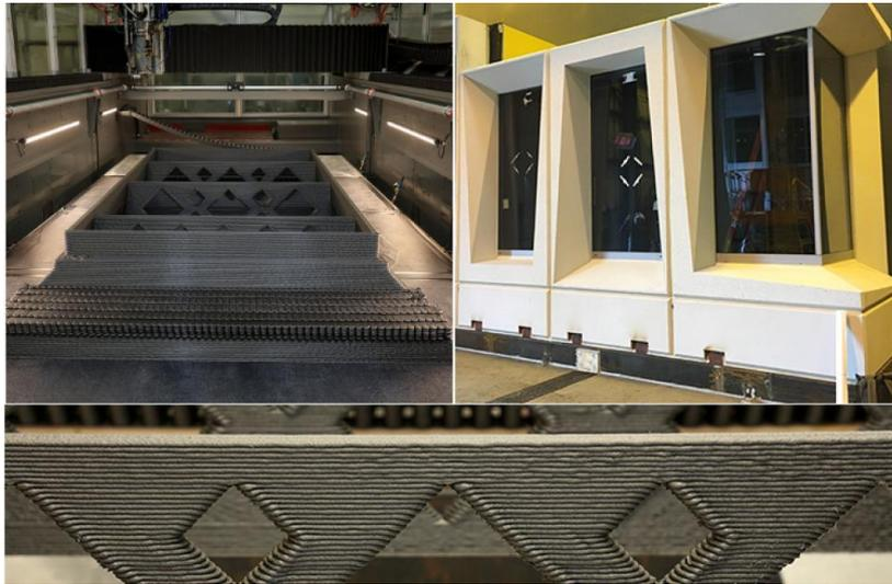
*ORNL utilizó molde impreso en 3D hecho de compuesto polimérico para fabricar componentes prefabricados de hormigón destinados a un edificio en Nueva York. Análisis tecnoeconómico realizado por investigadores resalta las ventajas en comparación con el uso de moldes de madera
