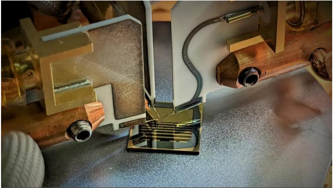
Chip milimétrico en el que se encuentran los transistores. Crédito: Anton Persson, Universidad de Lund
