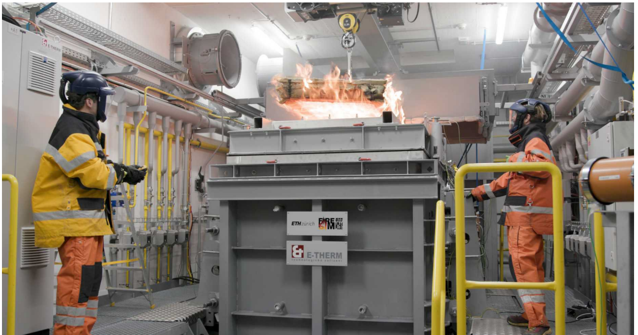
Transcurridos 90 minutos, la pieza de madera se retira del horno y se apaga. Crédito: Michael Steiner, Escuela Politécnica Federal de Zúrich
