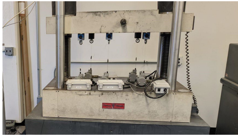
Sensores inalámbricos alimentados por energía solar desarrollados por los ingenieros de Drexel podrían permitir el monitoreo continuo de los puentes. Crédito: Universidad de Drexel
