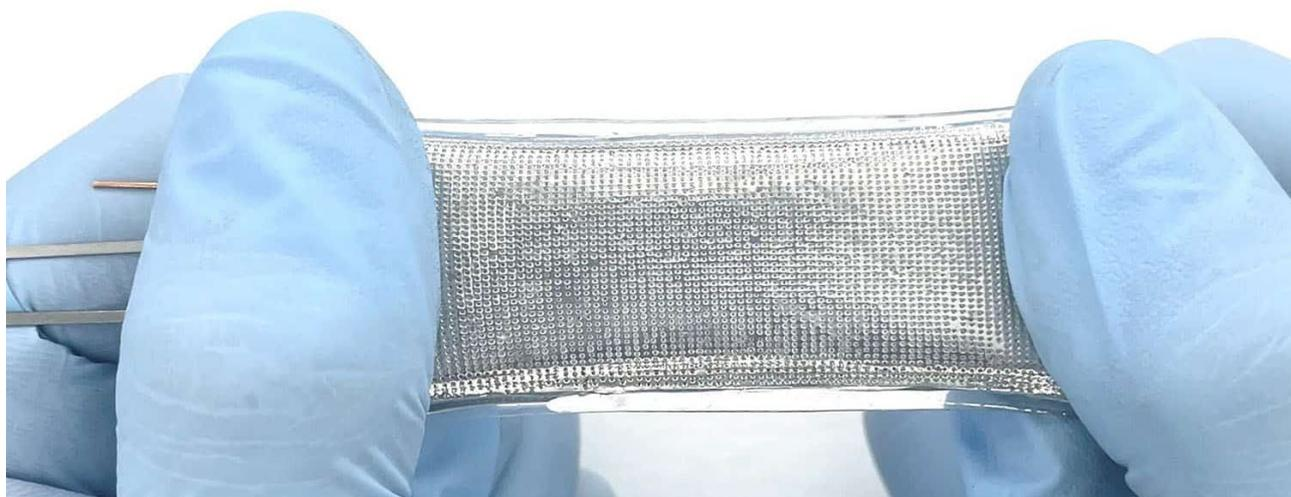
*Contenedor fabricado con el nuevo material que es elástico, flexible e impermeable tanto a gases como a líquidos*
