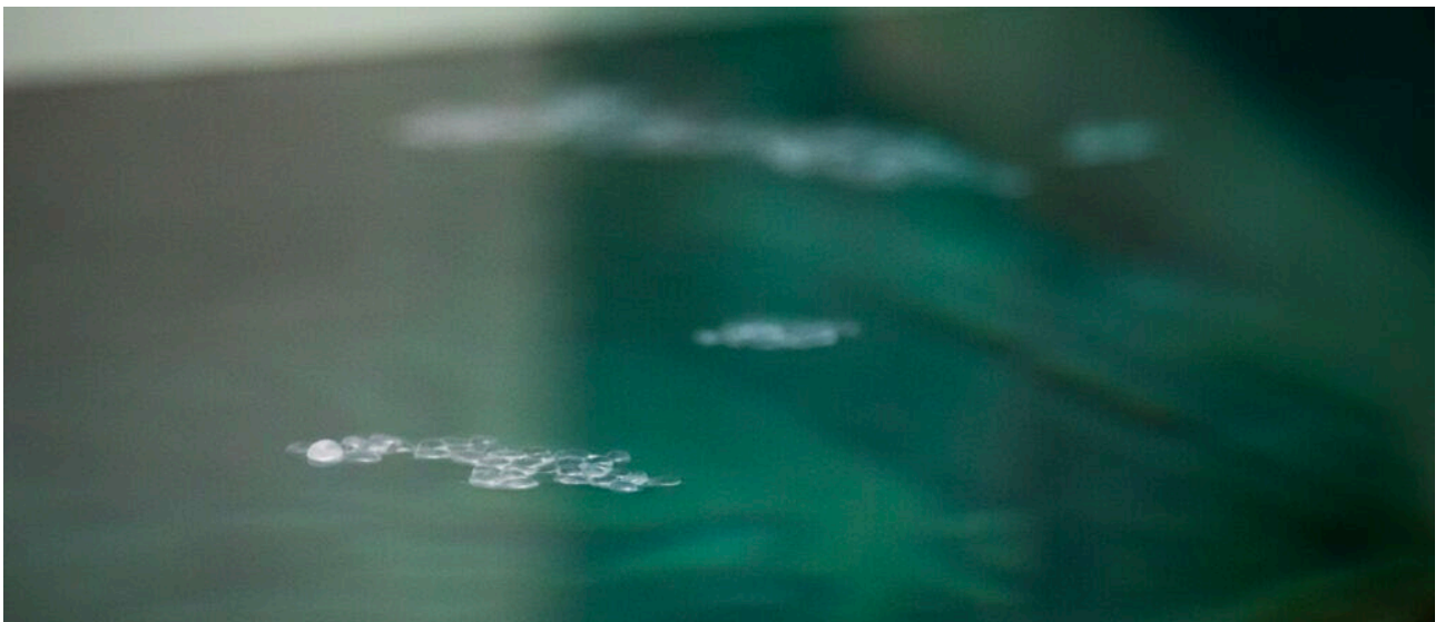
Los gránulos de microplástico flotan en la superficie del agua en el tanque de ondas de viento en el Laboratorio de Hidrodinámica Marina de la U-M como parte de un estudio para determinar cómo afectan las mediciones de la rugosidad de la superficie. Crédito: Robert Coelius, Michigan Engineering
